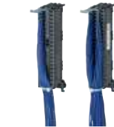
Kablo bağlantısı yapılmış S7-1500 ön konnektörü
